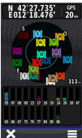
La pagina Satelliti visualizza i satelliti attualmente agganciati. Questo ricevitore aggancia anche i satelliti GLONASS. A destra oltre ai satelliti e' indicata la precisione della posizione espressa in metri. Il GPS supporta la ricezione dei satelliti WAAS-EGNOS. Il WAAS (Wide Area Augmentation System) è un sistema di correzione dei segnali dei satelliti, ideato per ottenere maggiore precisione nel calcolo della posizione.
