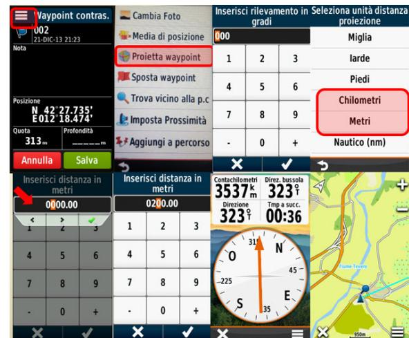
Marcare un Waypoint. Dalla finestra di registrazione sarà possibile attivare la Proiezione wpt per poi inserire l'angolo e la distanza (coordinate polari) e attivare la navigazione verso il punto.
