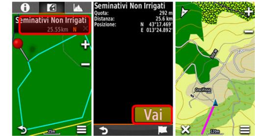
Raggiunto il punto la navigazione si dovrebbe interrompere automaticamente, altrimenti accedere alla pagina "Dove si va?" per interromperla. Questo è il modo da adottare per raggiungere una Zona di ricerca. Il Trackbak, cioè percorrere in automatico una traccia al contrario per ritornare al punto di partenza è attivabile solo con la "Traccia corrente" oppure è necessario registrare una copia invertita della traccia.
