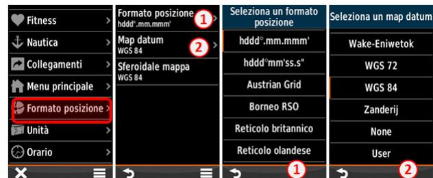
Dalle Impostazioni si accede al Formato Posizione dove si potrà impostare: 1 "Formato Posizione"; 2 "Map Datum". Lo "Sferoidale mappa" sarà impostato automaticamente.
